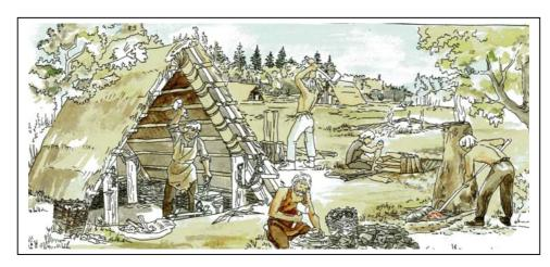
Germanen bei der Arbeit: Vorne zerkleinert ein Arbeiter mit einem Hammer das Eisenerz, links sieht man einen Schmied bei der Arbeit in der Schmiedehütte, rechts kontrolliert ein Hüttenarbeiter den Abstich am Rennfeuerofen, im Hintergrund bereiten Männer Buchenholz vor, um Holzkohle als Brennstoff für den Rennfeuerofen zu produzieren (meilern).
